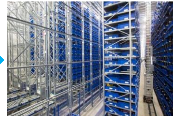
Einlagerung der KLT ins AKL
